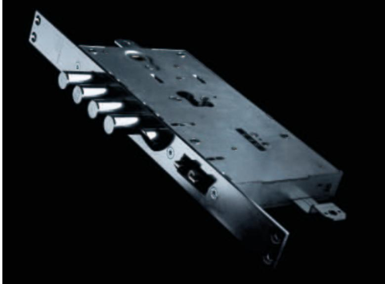
x1R Smart ist ein elektronisches Motorschloss, das speziell für den Einsatz an stahlverstärkten Türen entwickelt wurde. Die Öffnungs- und Schließfunktionen werden durch einen Motor und eine elektronische Karte mit einem hochmodernen Mikroprozessor gesteuert. Auch bei einem Stromausfall kann die Tür mit dem mechanischen Schlüssel geöffnet werden, der dank eines Sicherheitssystems den Motor während der Aktivierung des mechanischen Zylinders abschaltet.
