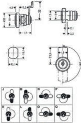
Durch Umlegen des Hebels erreichen Sie die angegebenen Schließwege
