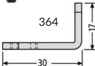
für altes System mit Befestigungsfeder
